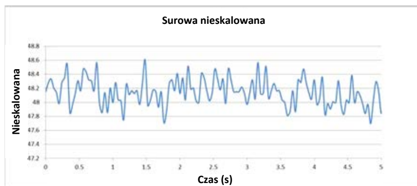
Rysunek 4: Przebieg surowego nieskalowanego sygnału wilgotności w przepływającym materiale
