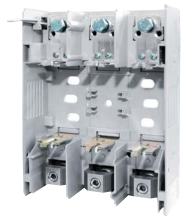
RBK 1 VD-M wykonanie do montażu na płycie montażowej, zdjęcie bez pokrywy oraz osłon zacisków, zacisk typu M u góry, zacisk typu V u dołu aparatu lub odwrotnie (RBK 1 VG-M)
