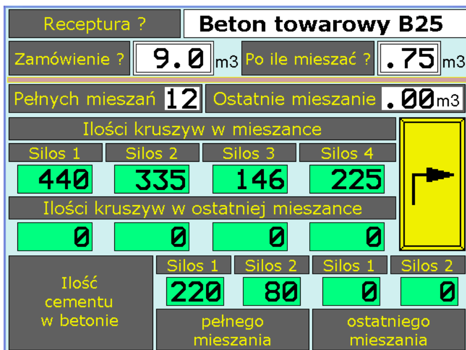
Rys. 2 Ekran dotyczący produkcji betonu.
