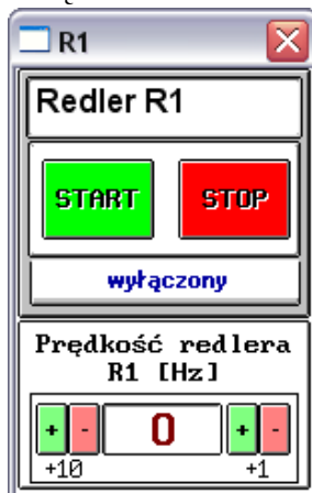
Rys.3. Okienko Start/Stop redlera, podnośnika, wentylatora i ślimaka
